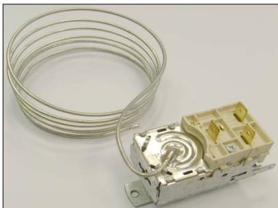
Das Frostschutzthermostat nimmt die Ventilatoren außer Betrieb, wenn bei einem Warmwasserheizregister Frostgefahr besteht. Das Fühlersystem schaltet bei einer Temperatur von ca. 7°C. Gleichzeitig wird ein optionales Magnetventil geöffnet.
