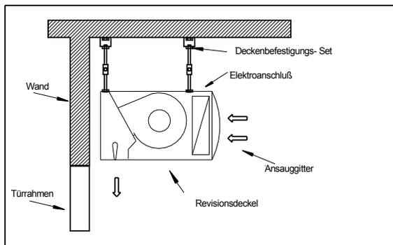
Das Gerät sollte so platziert werden, dass der Luftschleier so nah wie möglich an der Türwand liegt und die Ausblashöhe möglichst mit der Türrahmenseite abschließt (siehe Zeichnung).
