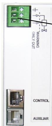
Das Magnetventil öffnet und schließt den Warmwasserkreislauf durch die Sommer- / Winterfunktion der Steuerung, um bei Sommerbetrieb oder Stillstand der Türluftschleieranlage den Heizungskreislauf energiesparend zu schließen.
